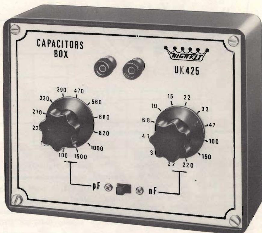
**I**l «Box di condensatori», **UK 425** è stato studiato e realizzato col preciso intento di fornire un valido aiuto, così come è stato fatto con il «Box di resistori» **UK 415**, nelle fasi di progettazione e di riparazione dei circuiti elettronici.
