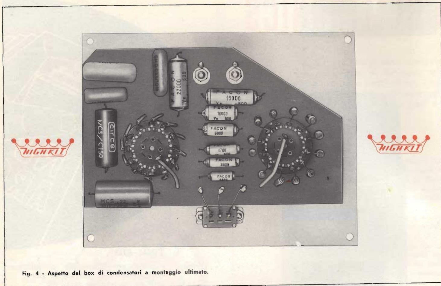
Fig. 4 - Aspetto del box di condensatori a montaggio ultimato.
