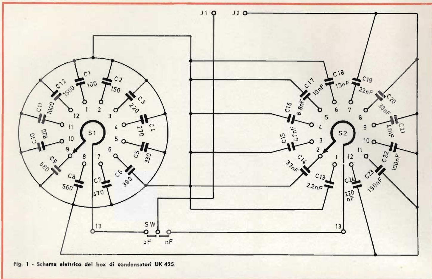
Fig. 1 - Schema elettrico del box di condensatori UK 425.
